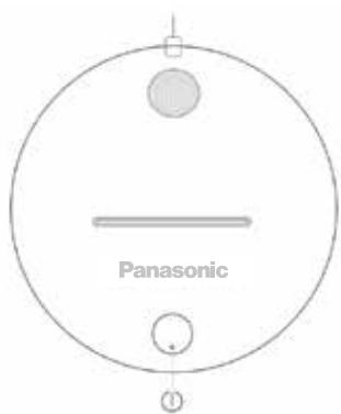
Nút cảm ứng (Chạm để chỉnh màu, giữ lâu để chỉnh sáng)
